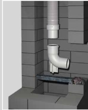
Flexrohr zuerst mit Adapter verbinden und in den Stützbogen stecken.
