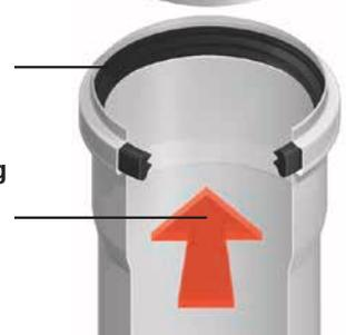
**Die Muffen der Abgasleitung müssen in Strömungsrichtung zeigen.**
